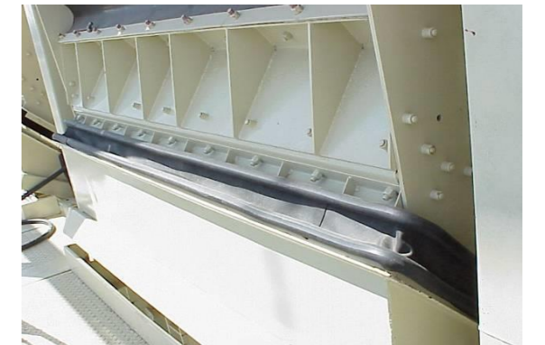
ラバーストリップでラバースカートを取付
