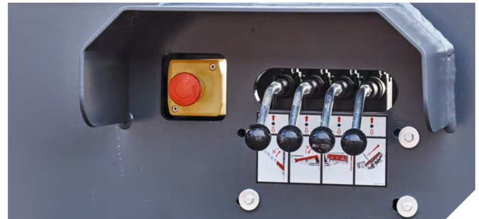
6カ所の非常停止、スタートサイレン、エンジン停止システム、尖った箇所の保護装置で安全確保
