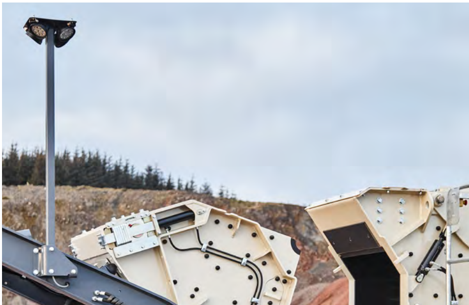
操作性と安全性を向上させるために、ワーキングライトを標準装備しています。
