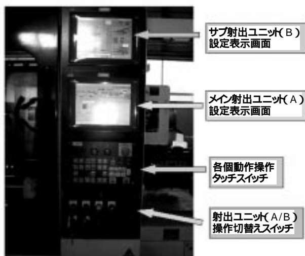
写真 3 設定・操作パネル
