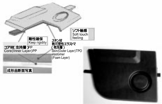
写真5 ECOPREST発泡成形 + 積層成形事例
