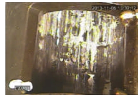
図 16. 注湯口近傍のスリーブ内面の比較
