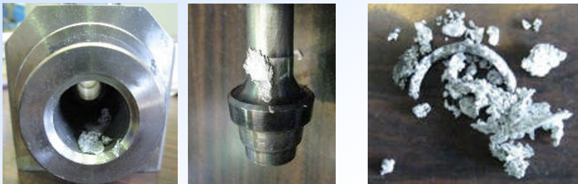
バルブ内へ進入したアルミ
