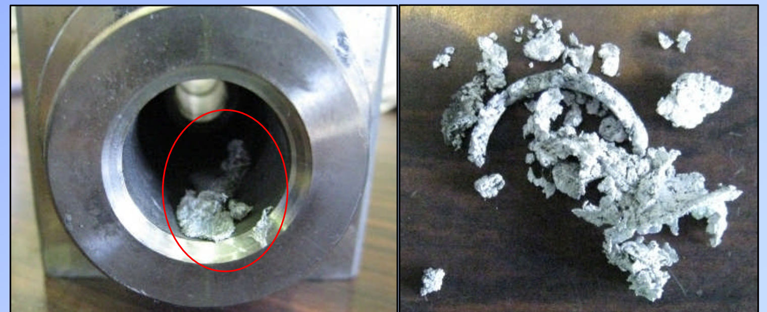
GFバルブ内へ進入したアルミ片
