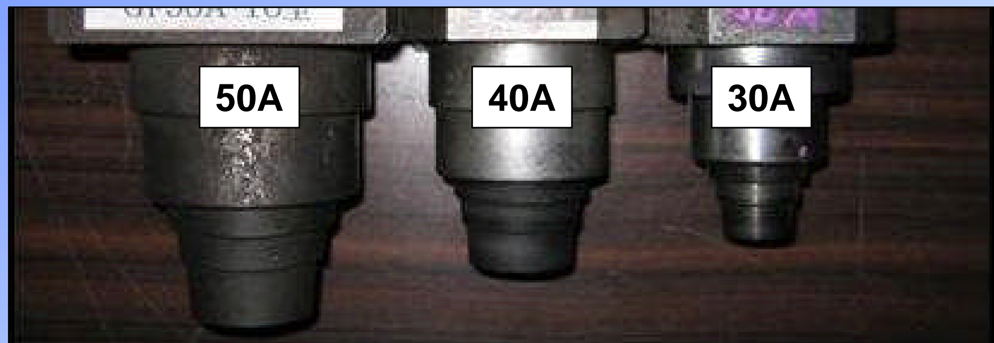
GFバルブ吸引口比較写真
