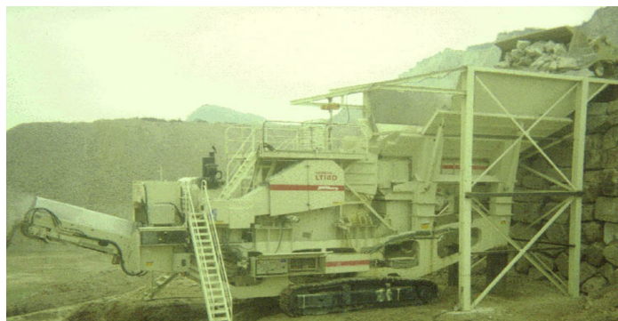
図-17 ダンプ直投入型 LT 用ホッパー（例） （顧客様の要望によりオプション開発）
