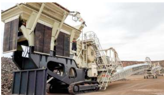
写真-⑥ 移動式破碎機+ロコリンク
