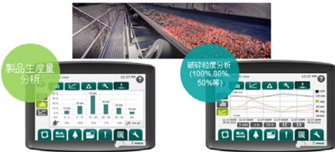
図-7 排出コンベヤ上の画像処理
