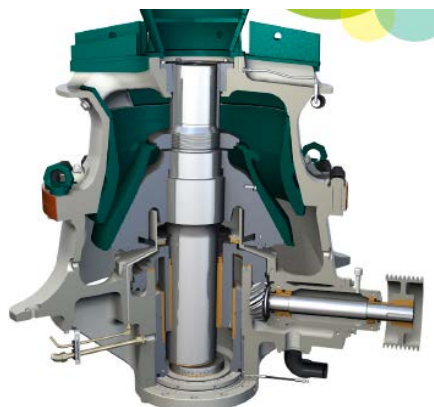
図-2 内部支持式コーンクラッシャ (GP)
