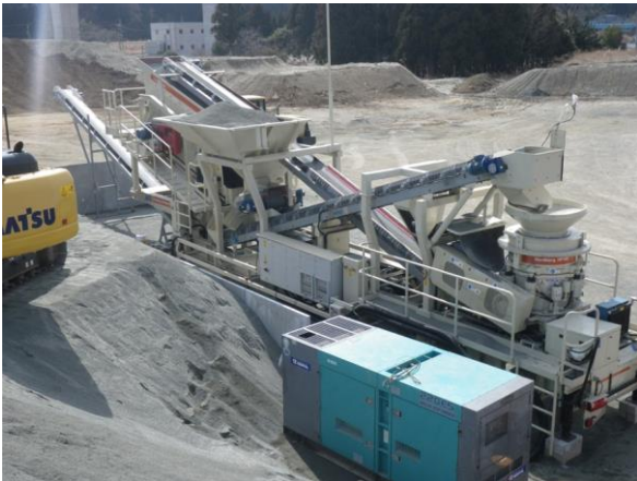
写真4 移動式砕砂製造設備NW100HP
