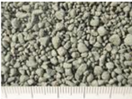
写真2 No. 2 製品粒形(2.5-1.2mm)
