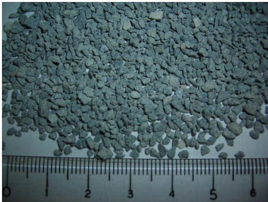
写真1 No. 1 製品粒形(2.5-1.2mm)
