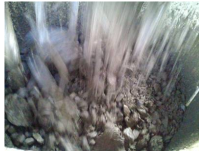
写真2 HP3 破碎室 (フルチョーク)
