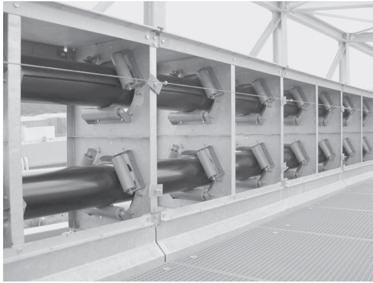
写真3 パイプコンベヤーの利点は、原石からの部品保護と完璧な粉塵防護です
