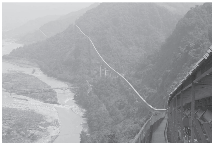
ベルコンによる運搬 —— 厳しい地形に左右されずスムーズな運搬が可能
