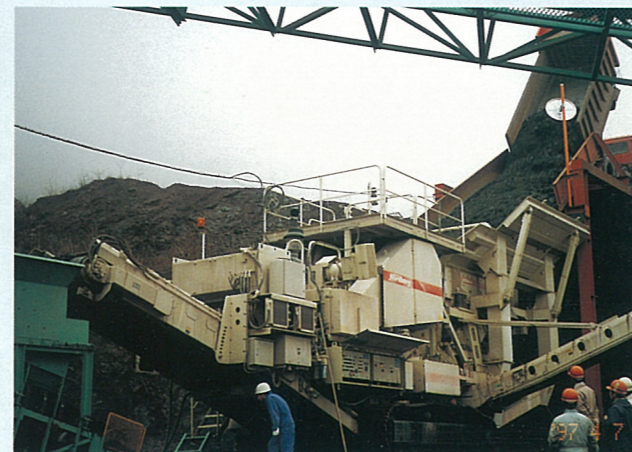
LT125. ホイールローダとダンプカーによる投入 (西武建材株式会社)
