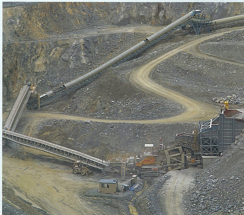
LT140およびロコリンクの組み合わせによるプラント全景 (住金鉱業株式会社)
