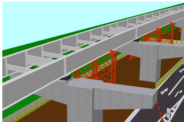
図 1 詳細度 200 モデル例 (2 主鋼桁の架設状況)
