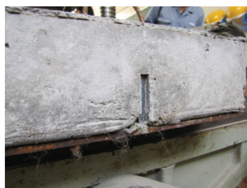
(d) 底鋼板とコンクリートのすべり (H-S-2 供試体)
